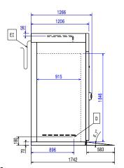
Vidange ΕI Connexion électrique Raccordement groupe à RO
